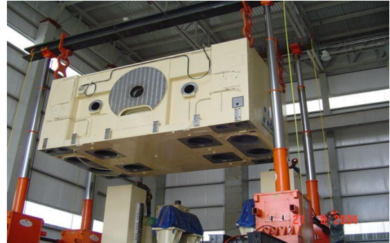
1 PRENSA CLEARING 500 TON
